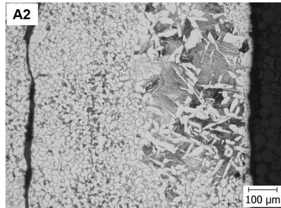
Fig. 8. Widmanstätten structure, hardness 119HV1.
